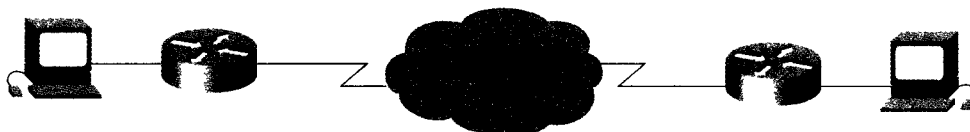
Рис. 3.2. Типичное соединение “точка-точка” передает данные через распределенную сеть WAN в удаленную сеть
