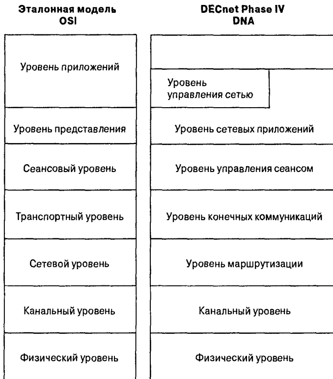
Рис. 40.2. Архитектура DNA DECnet Phase IV состоит из восьми уровней, соответствующих уровням эталонной модели OSI
