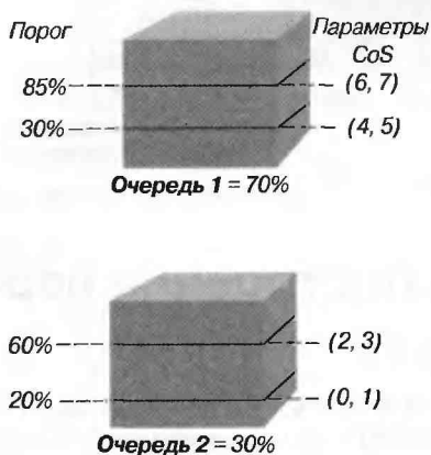
Рис. 59.15. SNA ToS в сочетании с DLSw позволяет преобразовывать SNA CoS в дифференцированное IP-обслуживание
