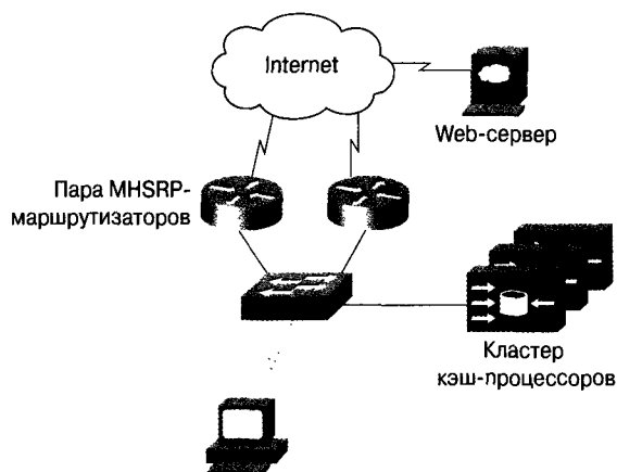
Рис. 54.7. Конфигурация полностью избыточного кэш-процессорного кластера
