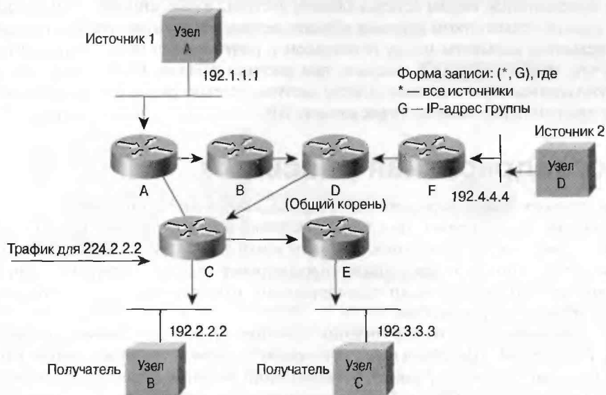
Рис. 45.9. Дерево общего доступа
