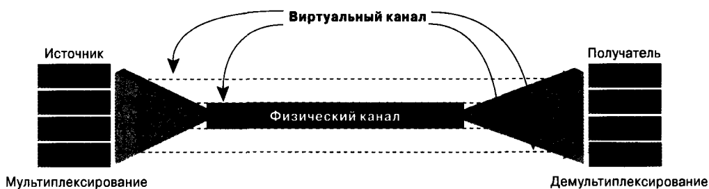
Рис. 17.3. Несколько виртуальных каналов могут быть мультиплексированы в один физический канал
