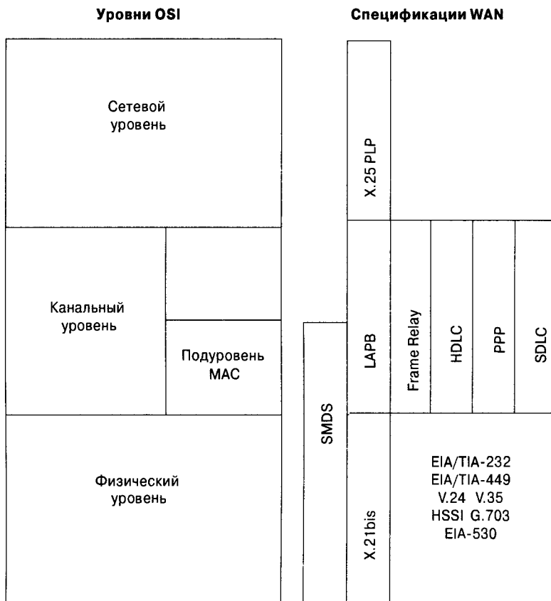
Рис. 3.1. Технологии распределенных сетей работают на трех нижних уровнях модели OSI
