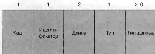
Рис. 26.1 Формат пакета протокола EAP
