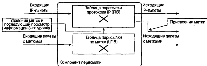
Рис. 32.5. Маршруты коммутации на граничном LSR-устройстве
