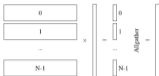
Рис. 1.22. Схема распределенного умножения матрицы на вектор в случае разбиения матрицы горизонтальными блоками
